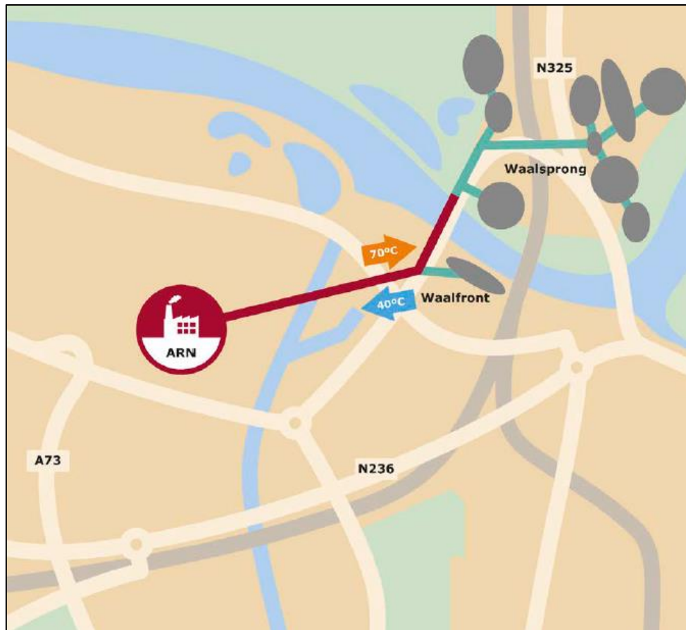
Figuur 4: Huidige midden-temperatuur warmtenet, de rode leiding is eigendom van Indigo, het groene net van Nuon. De grijze vlekken zijn de concessiegebieden waar de huizen zijn aangesloten op het Warmtenet Nijmegen (Gemeentelijke Rekenkamer Nijmegen, 2018).
